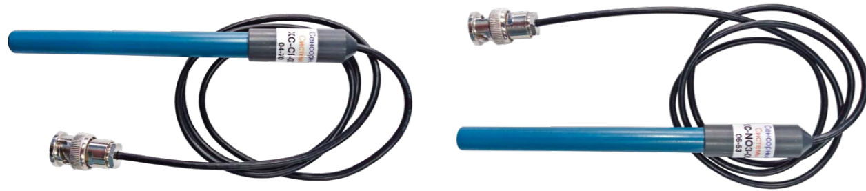
Рисунок 4.5.1. Измерительные электроды pH, нитрат- и хлорид-ионов
