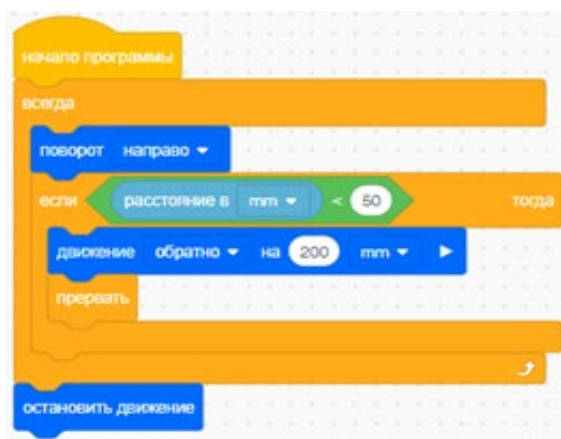
Рис. 30. Программа для демонстрации работы цикла прерывания
