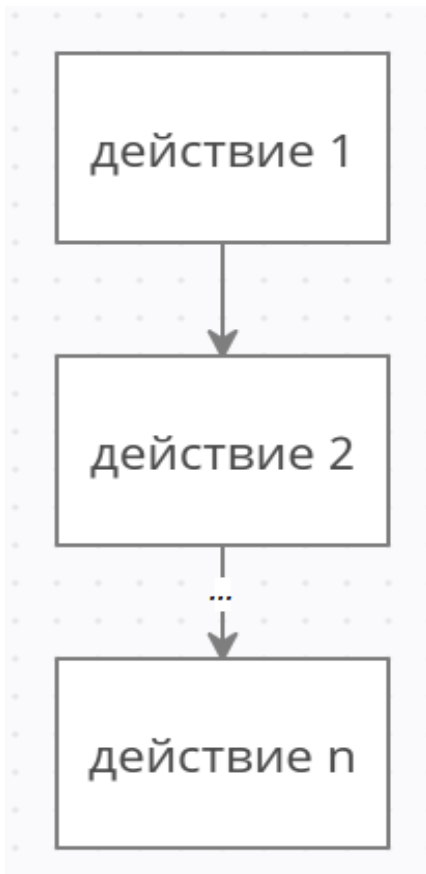
Рис. 107. Блок-схема линейного алгоритма
