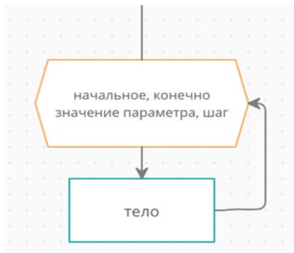
Рис. 58. Блок-схема цикла с параметром
