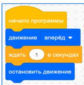
Рис. 18. Пример программы с использованием блока Ожидания
